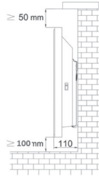
Şekil 11. Isıtıcının montaj olmuş ölçüleri
